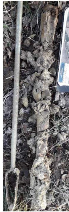
Sd 13 : Prairies améliorées à dactyle avec écoulement d'eau Sol argilo-limoneux brun-gris → 25 cm puis sol argilo-limoneux g et G: 25 → 50 cm, puis avec G : 50 → 80 cm, ZH
