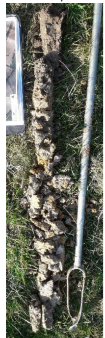
Sd 7 : Prairies améliorées, graminées avec joncs Sol argilo-limoneux brun → 25 cm puis sol argilo-limoneux ocre et gris (g) : 25 → 80 cm puis sol argilo-limoneux avec graviers, gris-bleu à Gley (G) : 80 cm → 90 cm, ZH
