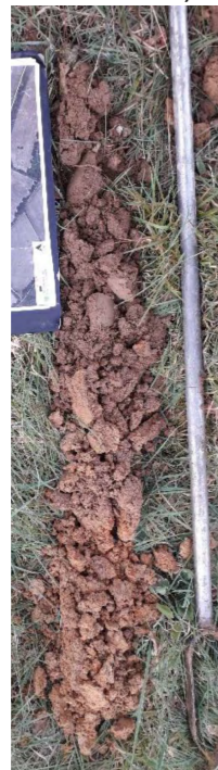
Sd 15 : Prairies améliorées avec différentes graminées sans joncs ici Sol argilo-limoneux brun → 50 cm puis sol argilo-limoneux jaune ocre (rares g): 50 → 80 cm, non ZH
