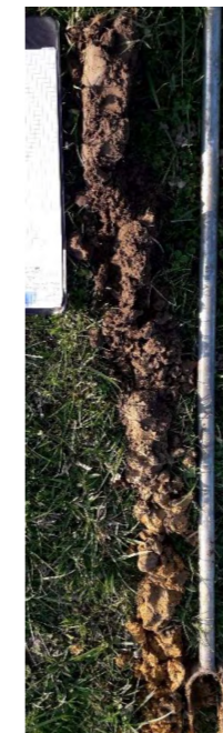
Sd 3 : Prairies améliorées, graminées Sol argilo-limoneux (+ sable et graviers) brun → 40 cm, puis ocre avec rares traces de g : 45 cm → 80 cm, traces de G vers 80 cm, non ZH
